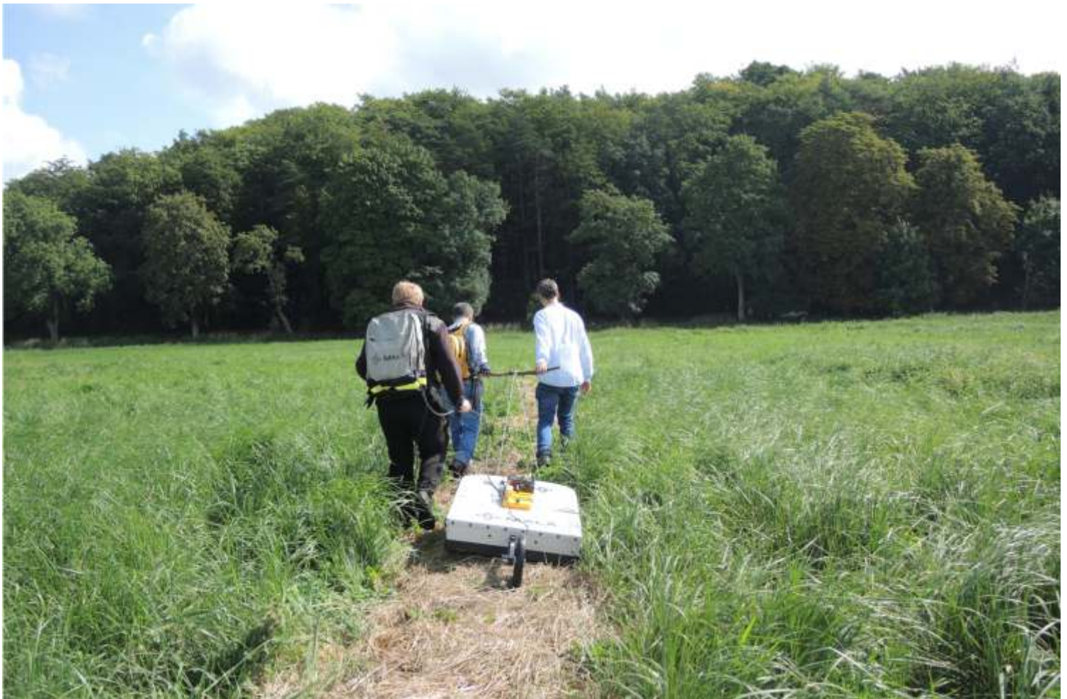
Georadar- Geländemessungen – auf der Suche nach dem Paläostrand auf der Insel Wollin, Foto: A. Strzelecka.
