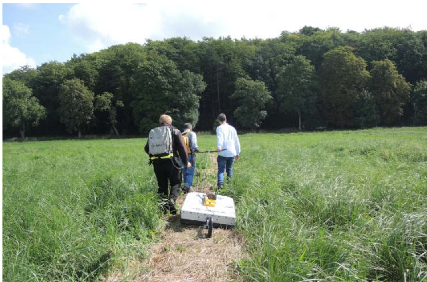
Terenowe badania georadarowe - w poszukiwaniu paleopłazy na wyspie Wolin, fot. A. Strzelecka
